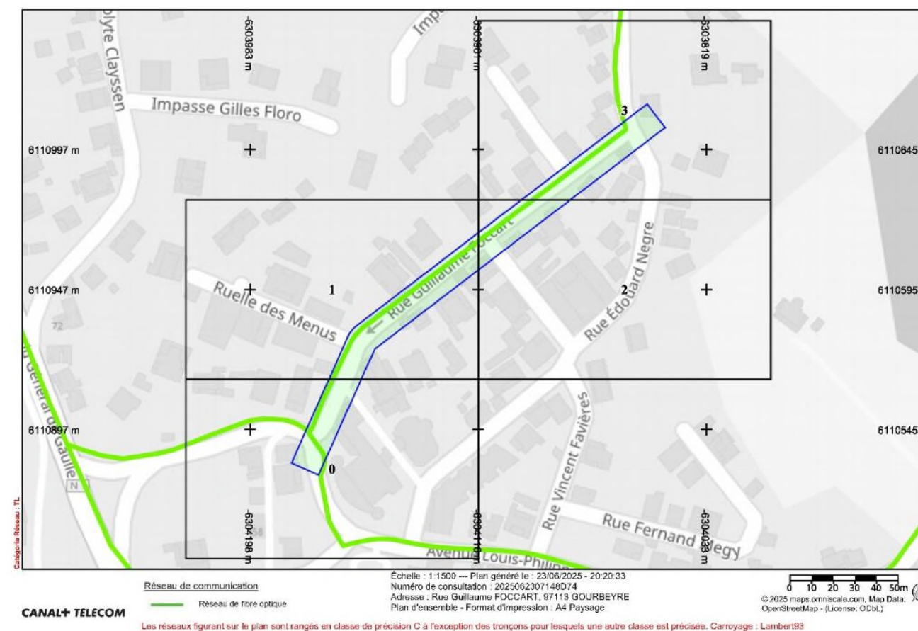
Figure 37 : Réseau Fibre CANAL+TELECOM rue Foccart
